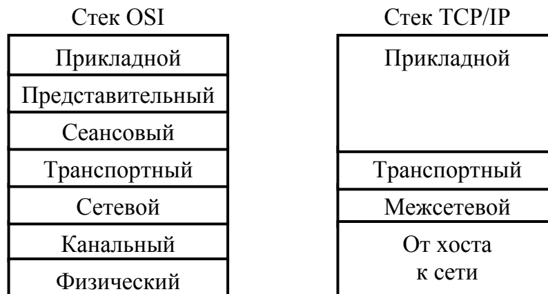
Рисунок 19 — Стеки OSI и TCP/IP
