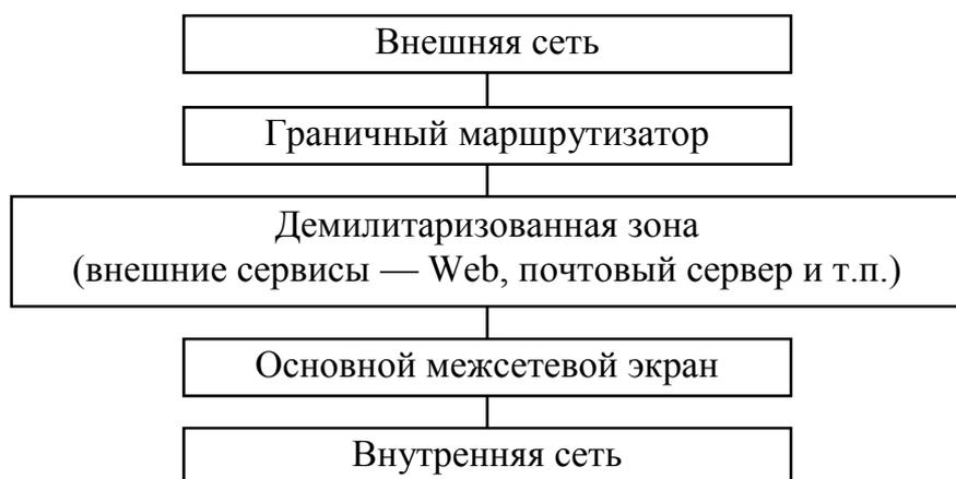
Рисунок 10 — Двухкомпонентное экранирование
