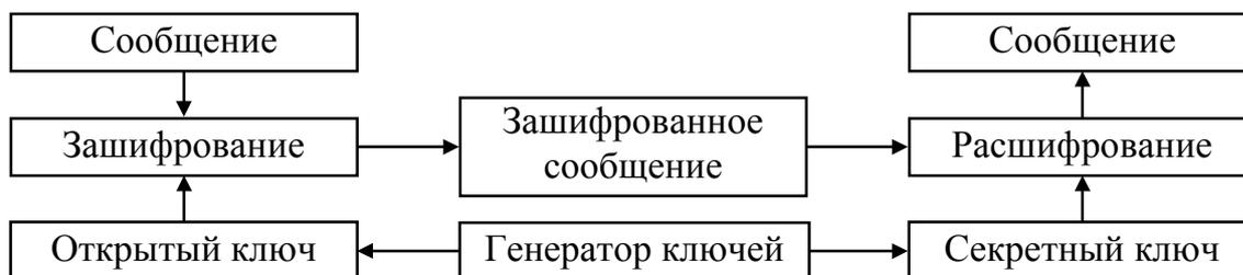
Рисунок 5 — Асимметричное шифрование
