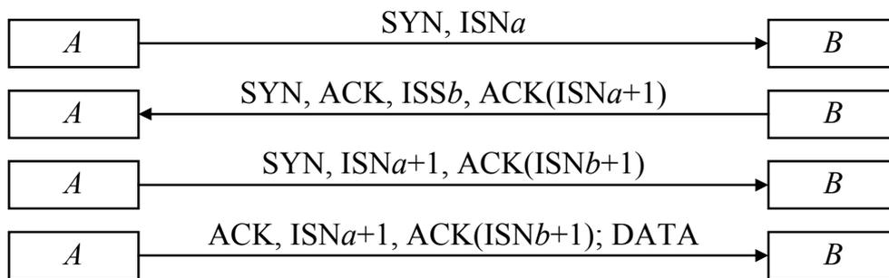
Рисунок 18 — Установление TCP-соединения
